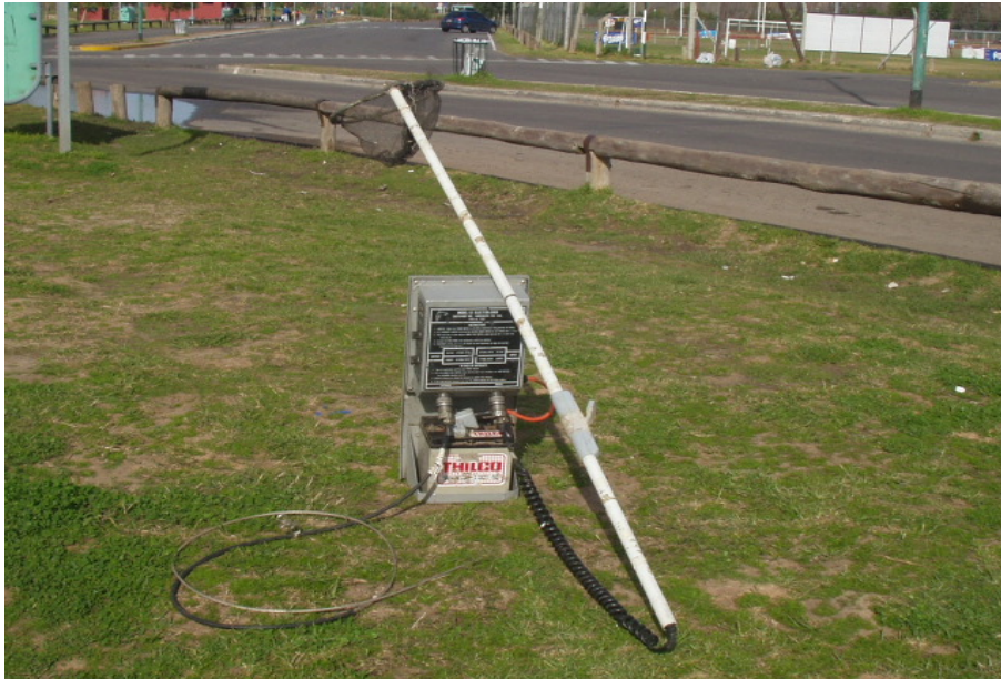
Foto 4. Equipo Smith-Root M12 portátil utilizado para la pesca experimental en zonas litorales y someras del río
